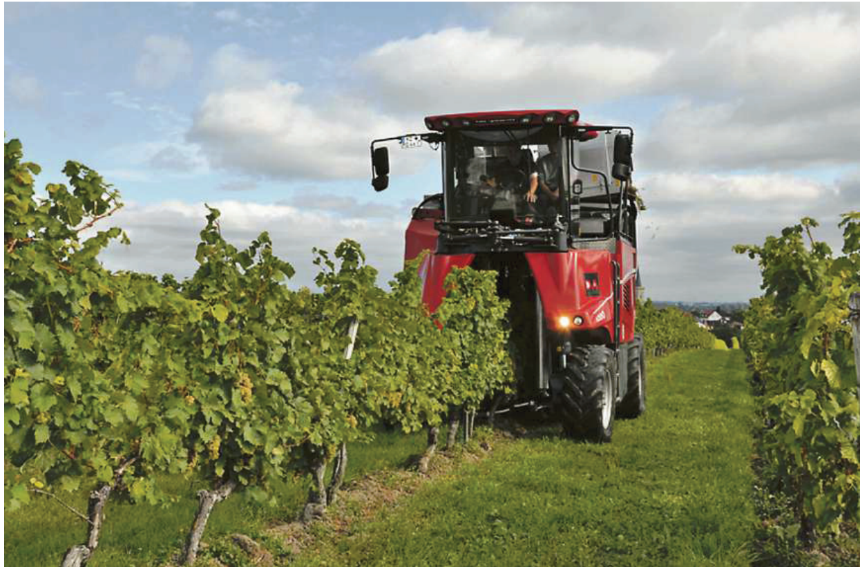
Zeile für Zeile rüttelt der Traubenvollernter die Trauben vom Rebstock. Insgesamt 2500 Liter Trauben fasst die Maschine. Foto: Miesch-Schmidt
